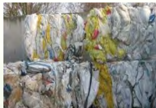
2. Prétraitement - mise en balle
